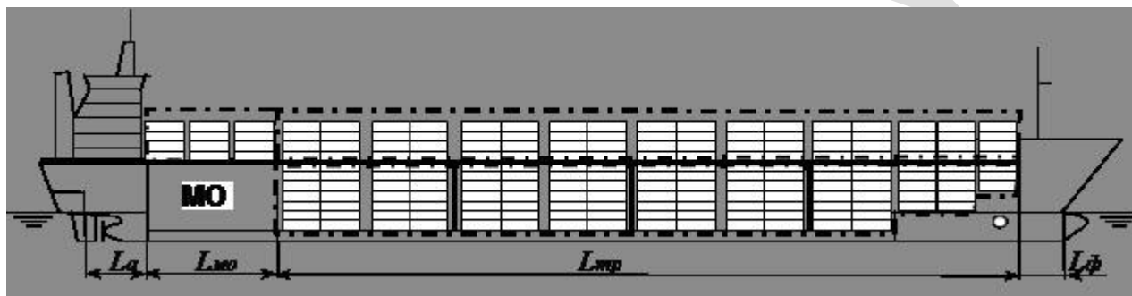
Рисунок 1 -Схема контейнеровоза с кормовым расположением надстройки
